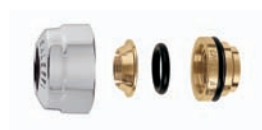
Raccordo meccanico, per tubi in rame ricotto, rame crudo, ottone, acciaio dolce e acciaio inox. A tenuta O-Ring. Pmax d'esercizio: 10 bar. Campo di temperatura: -25÷120°C. Cromato lucido.
